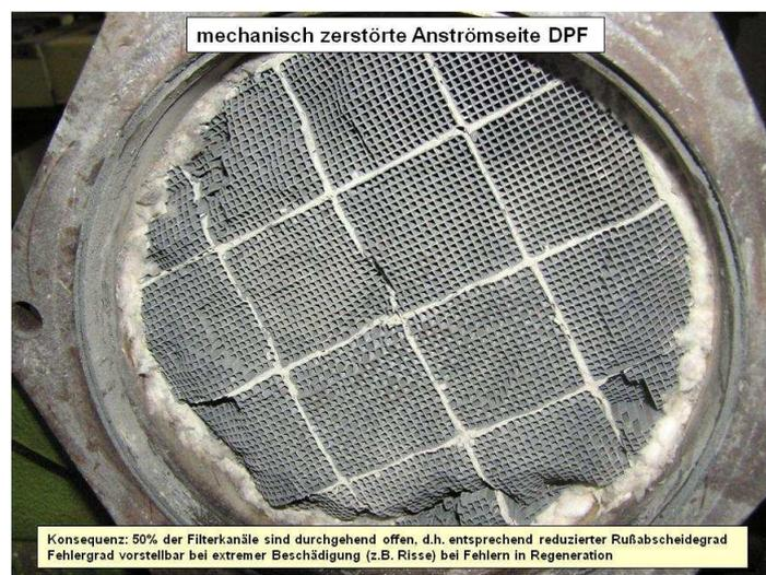
**Abb. 6.2: DPF mit zerstörtem Einlassquerschnitt für Fahrzeug *Diesel II***
