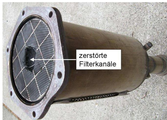
**Abb. 4.34: Mechanisch zerstörter DPF für AU-Messungen am *Diesel 4***
