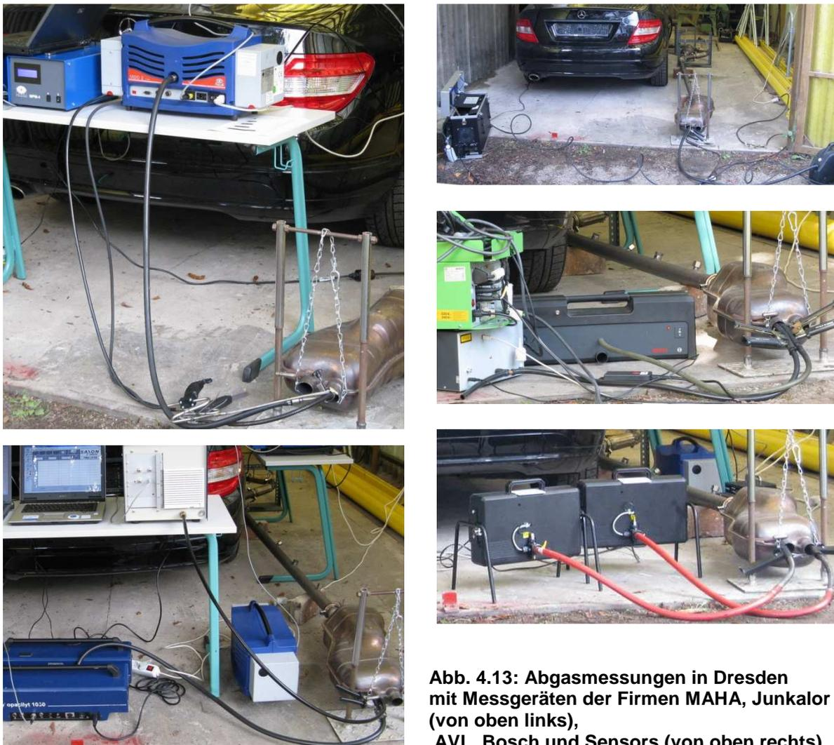
Abb. 4.13: Abgasmessungen in Dresden mit Messgeräten der Firmen MAHA, Junkalor (von oben links), AVL, Bosch und Sensors (von oben rechts)
